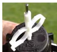
FloStop перекрывает поток воды с отдельных головок дождевателей при работающей системе. Это удобно для замены или отключения конкретных головок во время технического обслуживания или строительных работ.
