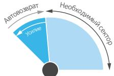
Эта запатентованная функция возвращает башенку дождевателя к изначальному сектору полива вне зависимости от того, куда она повернута. Механизм привода с несрываемой резьбой защищен от повреждений и вандализма.
