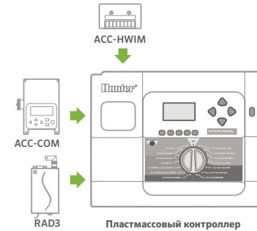
**Коммуникационные компоненты ACC, установленного на стене**
