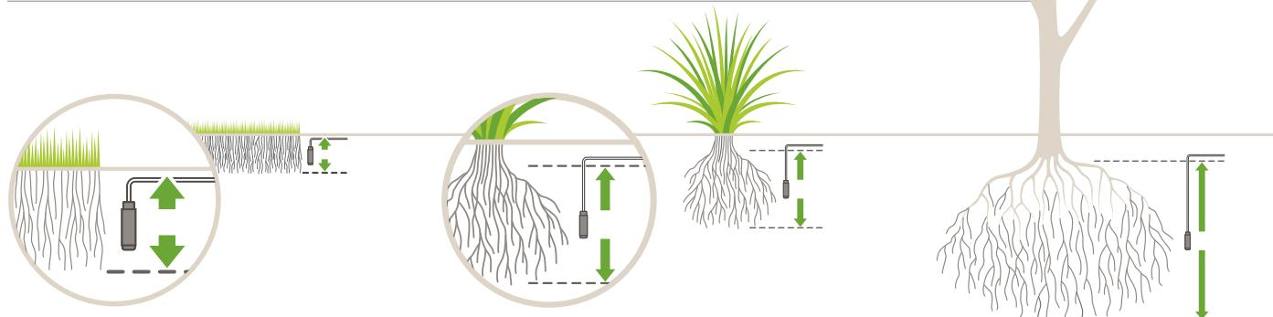
При использовании в дерне датчик следует располагать в корневой зоне, на глубине приблизительно 15 см (это значение может быть изменено в соответствии с состоянием дерна).
