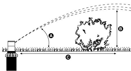
Эти таблицы траектории роторных дождевателей созданы для определения того, насколько близко дождеватель может быть расположен к объекту, например, ограде или кустарнику без преграждения направления полива. Вся информация приводится для оптимального эксплуатационного давления.
