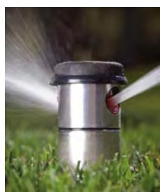
Модель с противопоставленными соплами обеспечивает отличное распределение воды. Основное и вторичное сопла расположены на противоположных сторонах башенки, и полив осуществляется в противоположном направлении по мере вращения дождевателя, чем достигается отличное покрытие в ближней к дождевателю и средней части сектора.
