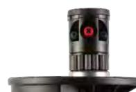
Установить сектора полива на регулируемом G885 просто и быстро. Встроенный храповой механизм позволяет простым поворотом штанги установить правостороннюю точку возврата. После этого используется кольцо регулировки, чтобы установить сектор полива и левостороннюю точку возврата. G885 можно также легко преобразовать в невозвратный роторный дождеватель с помощью нашей эксклюзивной функции QuickSet-360.
