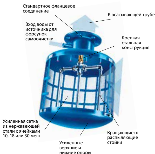
САМООЧИЩАЮЩИЙСЯ ФИЛЬТР ВСАСЫВАЮЩЕГО ПАТРУБКА
