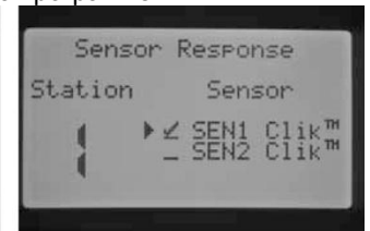
Только 1й датчик запрограммирован на 1ю зону
