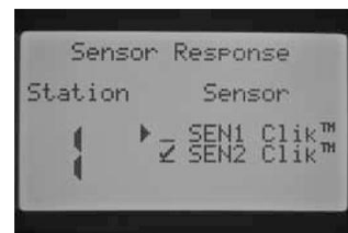
Только 2й датчик запрограммирован на 1ю зону
