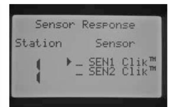
Ни один датчик не запрограммирован на 1ю зону
