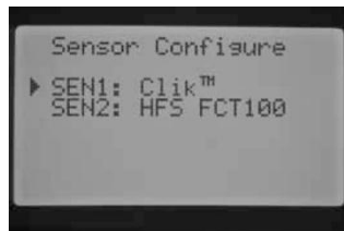
SEN 1 – метеодатчик SEN2 – датчик потока (HFS FCT100)
