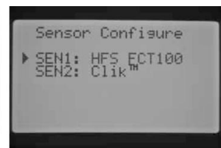
SEN 1 – датчик потока (HFS FCT100) SEN2 – метеодатчик
