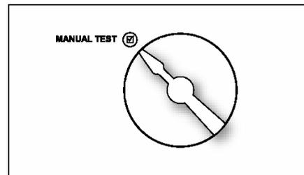
используемой зоне полива или короткое замыкание в любой точке выхода (в основном клапане или любой зоне). Если в момент поворота переключателя в положение запуска ручного тестирования системы (MANUAL TEST) дисплей отображает сообщение об ошибке (FAULT), следует перейти в режим «Расширенных функций», чтобы опознать эту ошибку.
